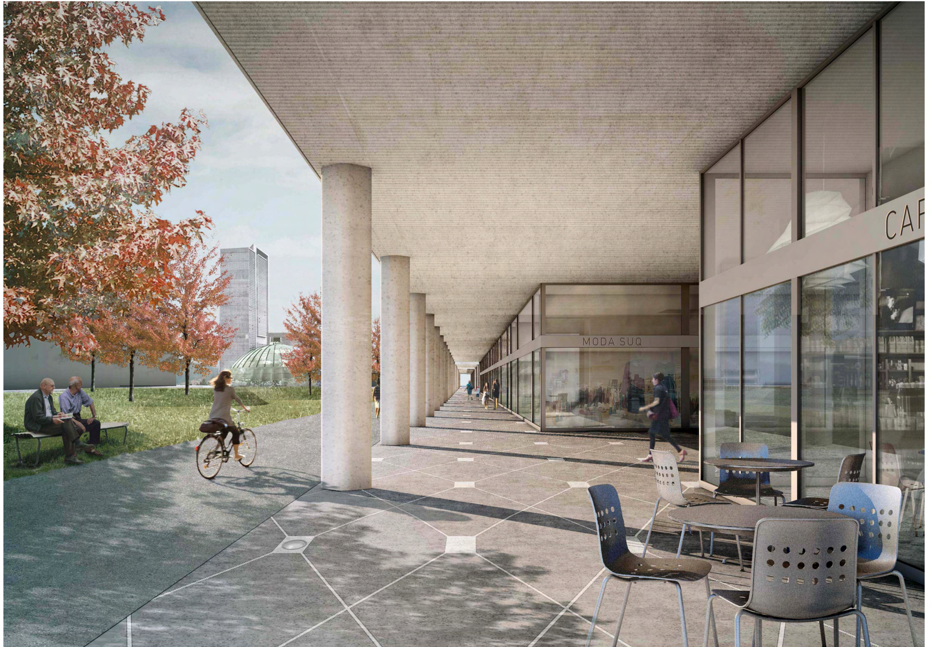
Die Arkade: Die Übereckstellung der leicht gerundeten Pilotis bewirkt eine stärkere Verzahnung zwischen Esplanade- und Arkadenraum als die orthogonale Stellung und rhythmisiert die 280 Meter lange Promenade Architectural.
