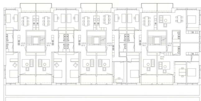
Grundriss 3.-5. Obergeschoss / Wohnungen / Gebäude A Massestab 1:200
