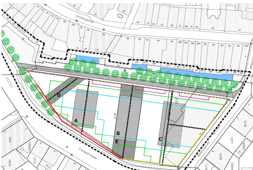
Ausschnitt aus dem Überbauungsplan Neumarkt-Gerbergasse mit der Neugestaltung der Gerbergasse und der Öffnung des Schüsskanals.
